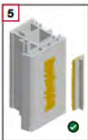
5 Strato di colla sul serramento \geq 80\% PROVA SUPERATA
