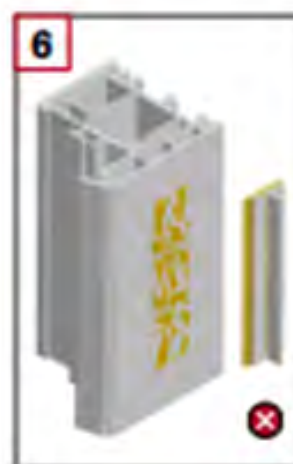
6 Strato di colla sul serramento < 80\% PROVA FALLITA
