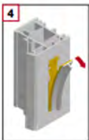
4 Strappare lentamente il campione di prova
