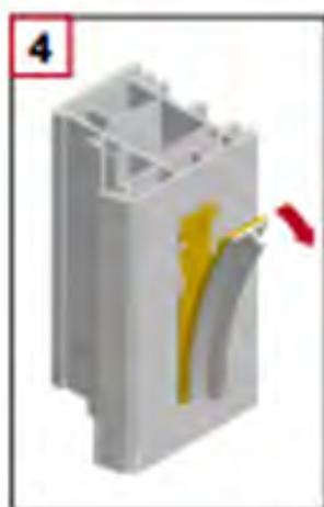
4 Strappare lentamente il campione di prova
